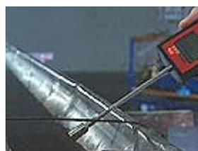
Messgerät zeigt Wasserstoff am Boden der Rinne an.
